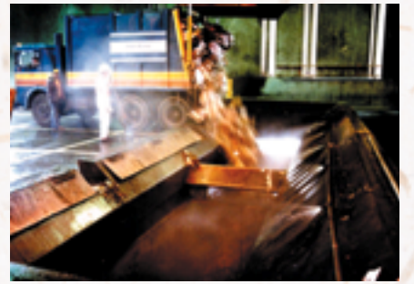
التفريغ داخل محطة النقل الوسيط
